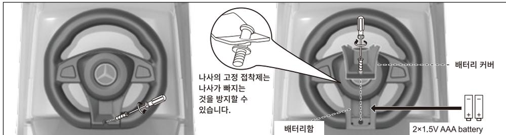
핸들의 배터리 커버를 열고 그림과 같이 AAA 배터리 2개를 양극과 음극을 맞춰 장착한 후 배터리 커버를 닫고 나사를 조여줍니다. (배터리 별매)
