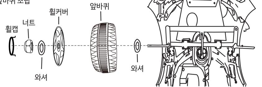
위의 그림처럼 앞바퀴 축에 [ 와셔 - 앞바퀴 - 휠커버 - 와셔 - 너트 - 휠캡 ]의 순서로 알맞게 조립합니다. (반대편 바퀴도 동일하게 조립)
