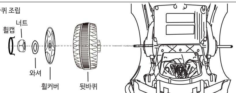
위의 그림처럼 뒷바퀴 축에 [ 뒷바퀴 - 휠커버 - 와셔 - 너트 - 휠캡 ] 순서로 알맞게 조립합니다. (반대편 바퀴도 동일하게 조립)
