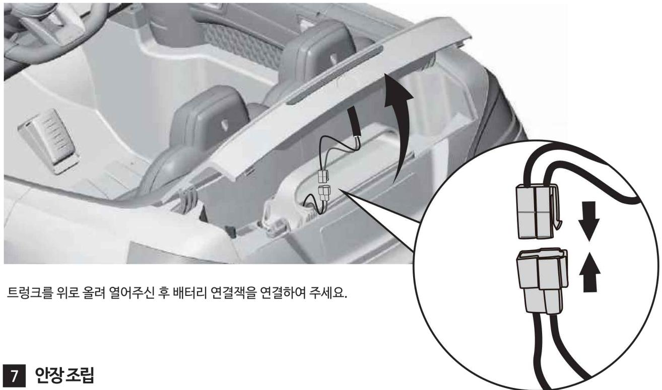
트렁크를 위로 올려 열어주신 후 배터리 연결잭을 연결하여 주세요.
