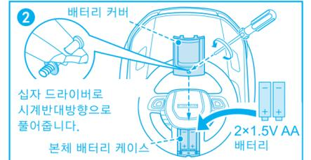
2 십자 드라이버로 배터리의 뚜껑을 분리한 뒤 AA배터리 두개를 넣고 배터리 커버를 닫습니다.
