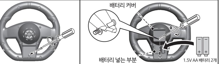
핸들 뒷부분의 배터리 커버를 탈거하신 후 1.5V AA배터리 2개를 넣어 주세요.
