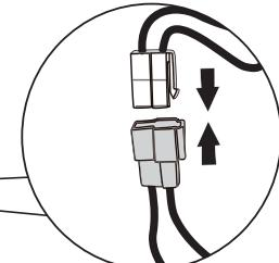
전동차 뒷쪽 트렁크를 열어보시면 축전지가 있으며, 위의 그림을 참고하여 배터리 연결잭을 연결하여주세요.
